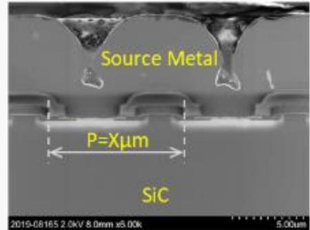
Fig.4: SiCトランジスタセル断面(詳細)
