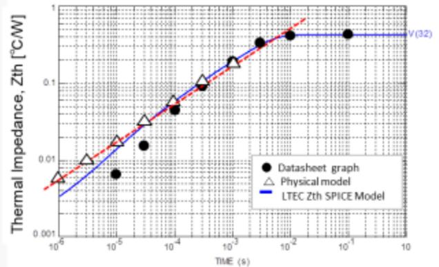
**Fig.29:** NVHL080N120SC1熱インピーダンスプロット データシートに記載されたデータ (●)、トランジスタの構造パラメータ (△)、およびLTEC合成のSPICEモデル (青い線) を使用して計算された熱インピーダンスを示す。
